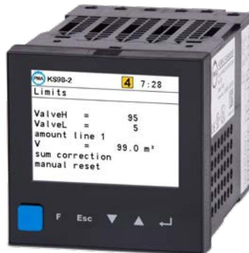
Positionsfeedback überwachen, ob Ventile Ihre Endlagen noch erreichen, bei Fehlfunktion entsprechende Fehlermeldungen generieren und so durch frühstmögliche Wartung weitere Schäden vermeiden.
