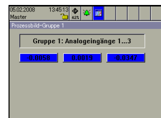
frei konfigurierbare Darstellung (über Setup-Programm) von analogen und binären Signalen und Hintergrundbildern Pro Gruppe ein Prozessbild
