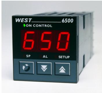
Der West 6500 bietet eine vereinfachte Bedienoberfläche sowie automatische Selbstoptimierung beim Aufstarten. Grüne LED für Ausgangsstatus und eine große 3-stellige Anzeige für gute Ablesbarkeit.
