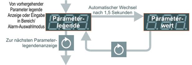
Wird der erforderliche Parameterwert angezeigt, können die Auf-/Abwärtstasten zur Änderung dieses Wertes verwendet werden; die neuen Werte werden sofort übernommen. Die Parametersequenz ist:
