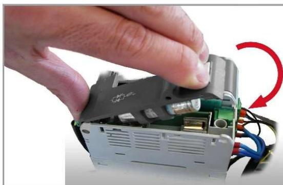
4. Mit etwas Druck, können Sie die Abdeckung schließen.
