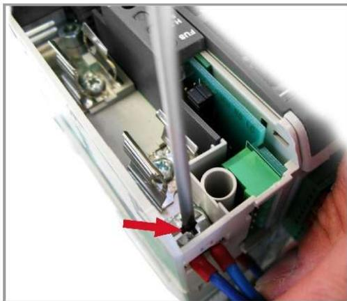
2. Verbinden Sie das Kabel mit L1
