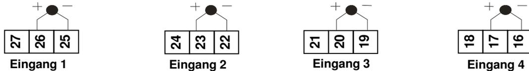
**Anmerkung:** Eingang 1 ist immer verfügbar, die Eingänge 2 und 3 sind nur bei Mehrkanal-Modulen vorhanden und Eingang 4 ist nur bei den Modellen Z4610 und Z4620 vorhanden.
