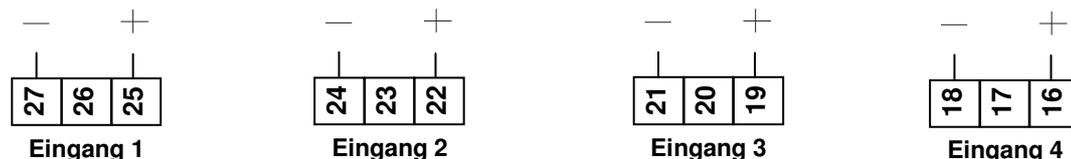
**Anmerkung:** Eingang 1 ist immer verfügbar, die Eingänge 2 und 3 sind nur bei Mehrkanal-Modulen vorhanden und Eingang 4 ist nur bei den Modellen Z4610 und Z4620 vorhanden.
