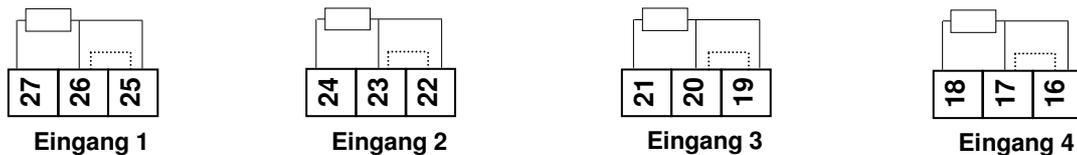
**Anmerkung:** Eingang 1 ist immer verfügbar, die Eingänge 2 und 3 sind nur bei Mehrkanal-Modulen vorhanden und Eingang 4 ist nur bei den Modellen Z4610 und Z4620 vorhanden.
