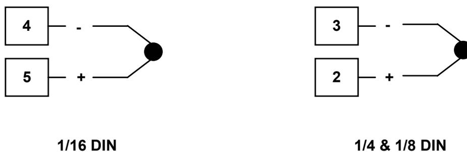
Bild 13 - Anschluss Universal – Eingang: Thermoelement
