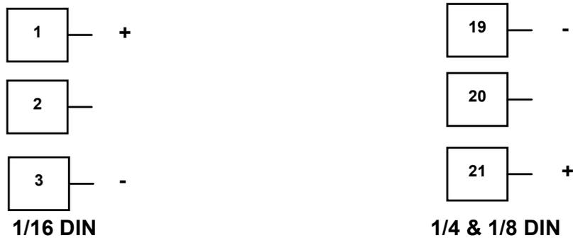
Bild 24 - Options-Steckplatz 1 - Linearspannungs- oder mA DC-Modul
