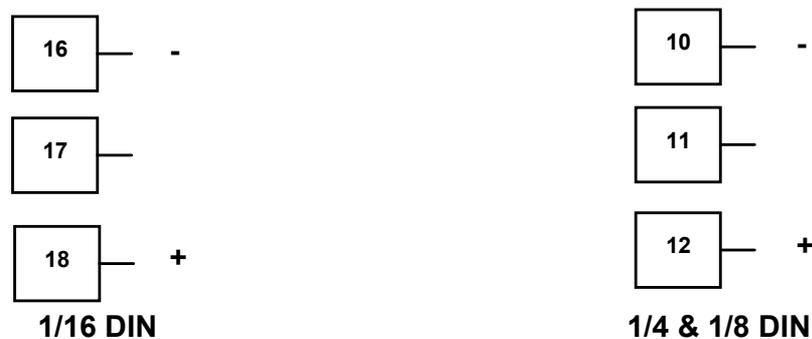
Bild 33 - Options-Steckplatz 3 - Messumformer-Stromversorgungsmodul
