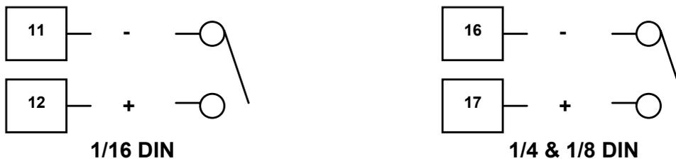
Bild 20 - Options-Steckplatz A – Digitales Eingangsmodul Wechselsollwert
