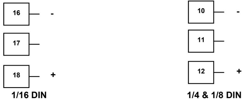
Bild 32 - Options-Steckplatz 3 - Linearspannungs- oder mA DC-Modul
