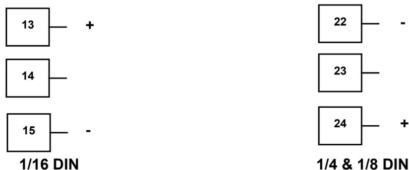
Bild 29 - Options-Steckplatz 2 - Linearspannungs- oder mA DC-Modul
