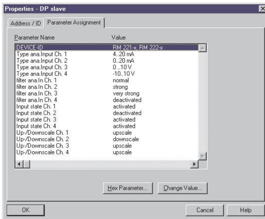
*Example STEP7: Parameter for analog input module RM 221-x/ RM 222-x*
