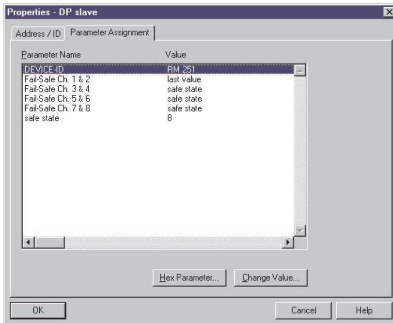
*Example STEP7: parameter of digital output module RM 251*
